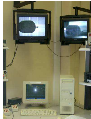
Figure 4 : Laboratoire du LNE ; positionnement du microphone par contrôle vidéo
